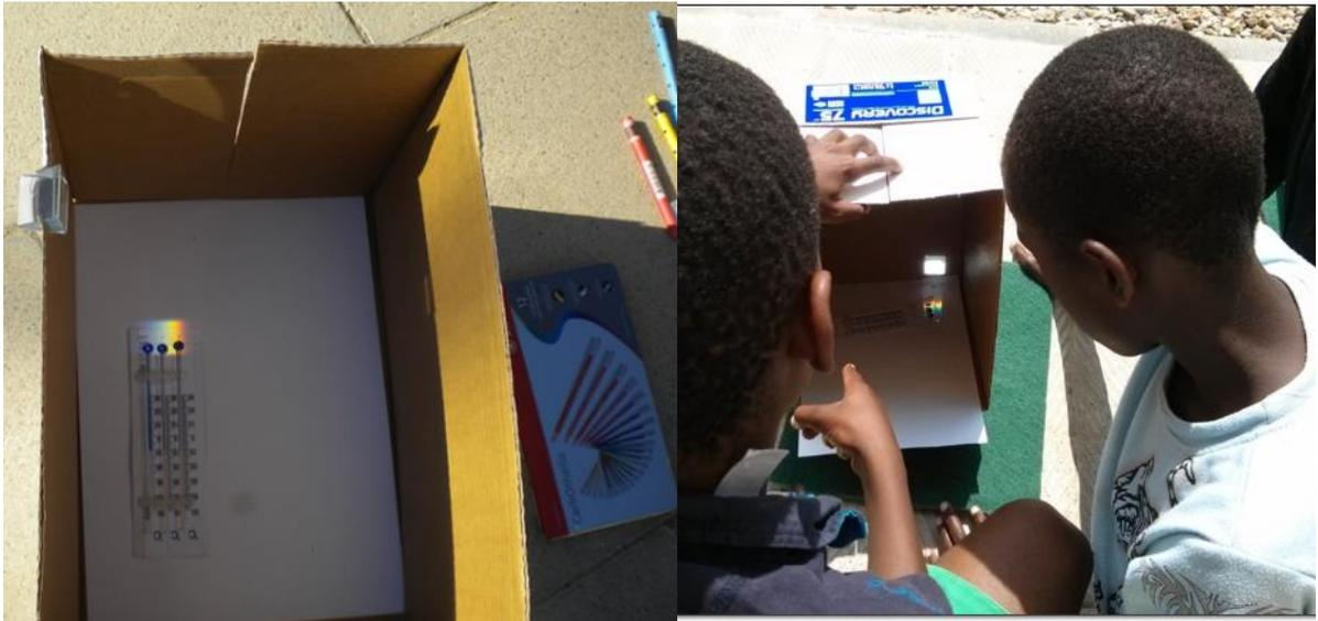
Con un prisma, una caja de cartón, tres termómetros muy bien alineados y un día soleado podemos construir un montaje como éste.
