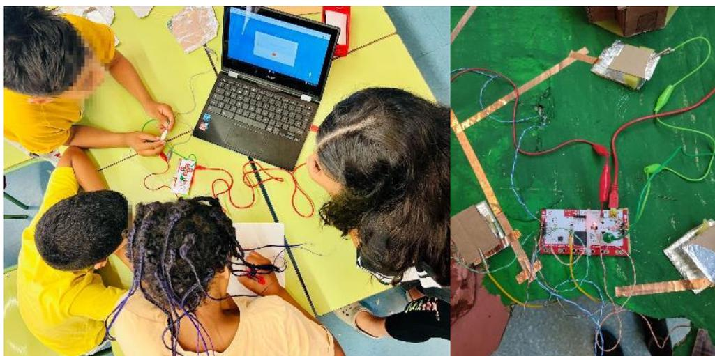
En las fotos podeis ver que usamos las pinzas cocodrilo para conectar la placa con los objetos. Pero, como hemos dicho, necesitamos pinzas cocodrilo también para conectar la masa (GND) del Makey Makey a la placa mediante el cable de cobre adhesivo.
