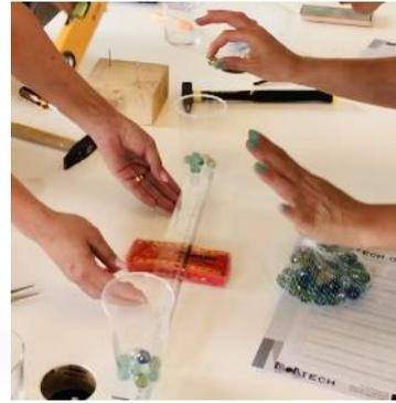
*EXPERIMENTO: Vamos a intentar levantar un peso directamente y después con el uso de una palanca. Podemos utilizar libros como resistencia (o un vaso de plástico con canicas, así será fácil variar el peso) y una goma como punto de apoyo y una regla como palanca.*
